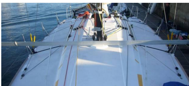
Photos 9 et 10 : Exemples d'installation de règle pour la mesure de hauteur de pied de mât
