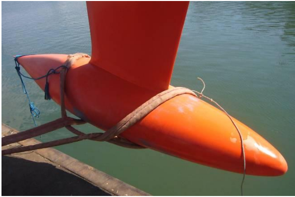
Photo 4 : Bulbe débordant devant avec bout arrière de protection de bord de fuite et bout avant de retrait du sanglage
