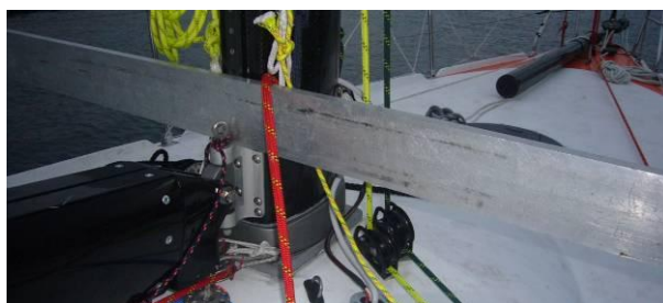
Photos 9 et 10 : Exemples d'installation de règle pour la mesure de hauteur de pied de mât
