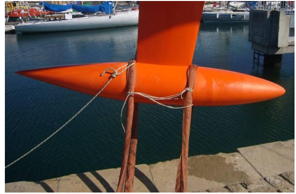
Photo 5 : Bulbe débordant devant avec bout arrière de retrait du sanglage + bout milieu de maintien des sangles avant de retrait du sanglage
