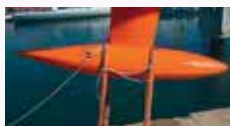
Bulbe débordant devant avec bout arrière de retrait du sanglage + bout milieu de maintien des sangles avant de retrait du sanglage.
