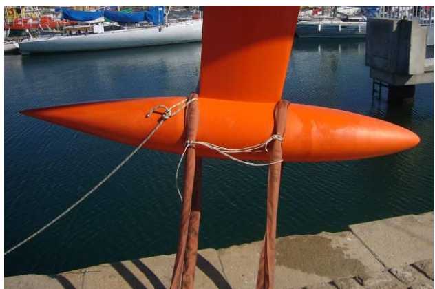
Photo 5 : Bulbe débordant devant avec bout arrière de retrait du sanglage + bout milieu de maintien des sangles
