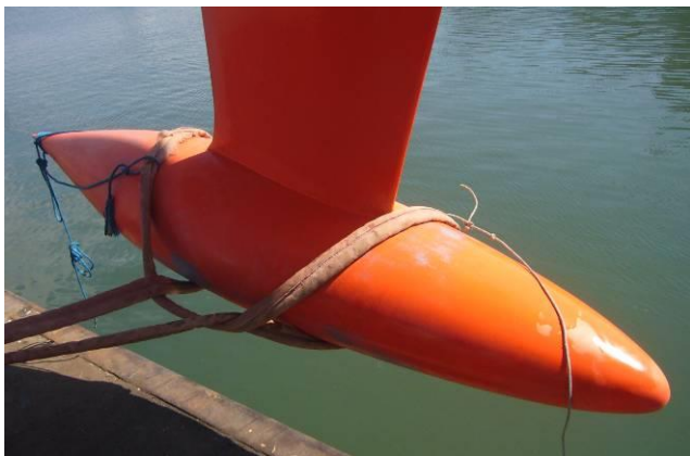
Photo 4 : Bulbe débordant devant avec bout arrière de protection de bord de fuite et bout avant de retrait du
