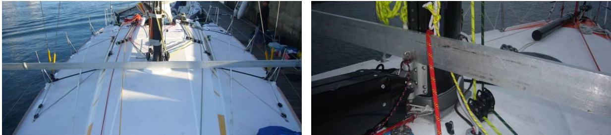
Photos 9 et 10 : Exemples d'installation de règle pour la mesure de hauteur de pied de mât
